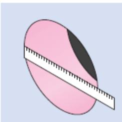
2. Změlte vnitřní průměr prostupu a ujistěte se, že otvor je v utěšňovací toleranci kruhového prostupu.
