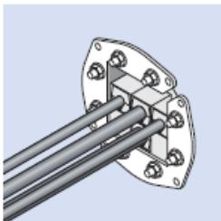
6. Vložte moduly do prostupu.
