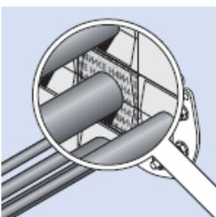
Barevné označení modulů umožňuje kontrolu správnosti instalace. Každá polovina modulu je barevně označena a má zároveň vyznačenou toleranci pro utěsnění kabelů.
