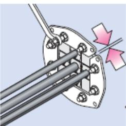
7. Stlačte přední díly zpět směrem do středu rámečku a utahujte postupně všechny matice na průchode. Matice dotáhněte tak, aby šroub přečípal minimálně 10 mm nad vrchní hranou matic.
