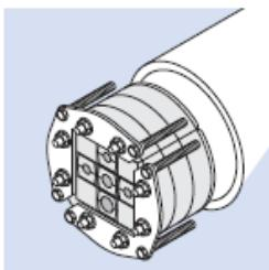
Demontáž prostupu se provádí uvolněním všech matic a pomocí šroubů M8, které se našroubují do připravených rohových závitových dř. Tím dojde k vytlačení prostupu.
