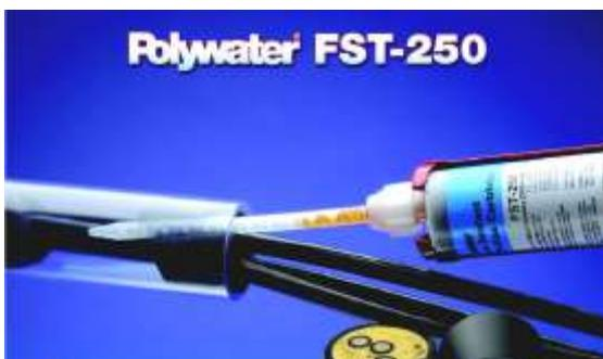
Das FST-Dichtungssystem kann als Kabeldichtung gegen Druckwasser verwendet werden. Es haftet gut auf Metallen, Kunststoffen und Beton. Es hält Wasserdruck 10m Wassersäule (1Bar). Es enthält eine Mehrzweck-Kartusche gefüllt mit Zwei-Komponenten-Schaum. Nach dem Drücken und der Anwendung vergrößert es mehrfach sein Volumen und versteift. Zur Anwendung kann eine übliche Druckpistole verwendet werden.
