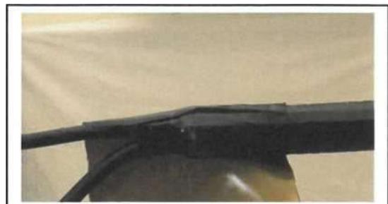
4. Erste Bandschicht J51 wird nach dem Aufrollen aufs Kabel
