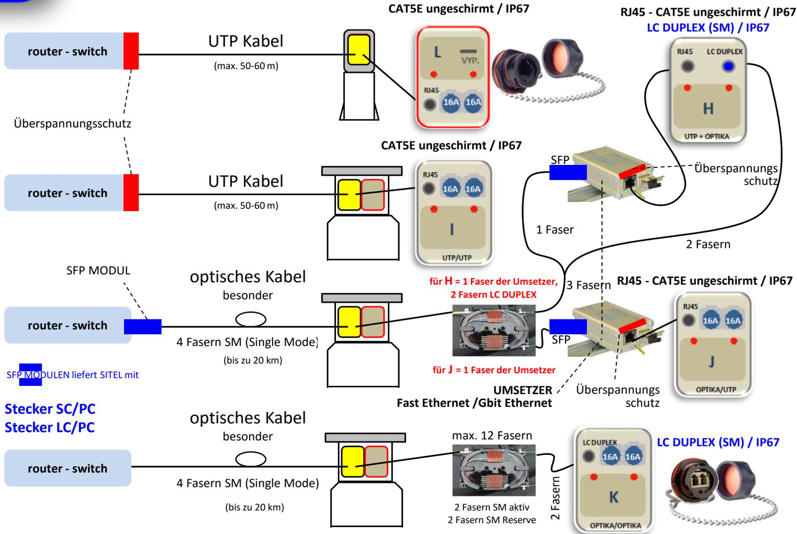
Auf Kundenwunsch liefern wir auch IP67-Stecker für den Anschluss an Datensteckdosen an Energiesäulen - nur der komplette Satz Verbindungsstück/Stecker - sorgt für die richtige Schutzstufe IP67.
