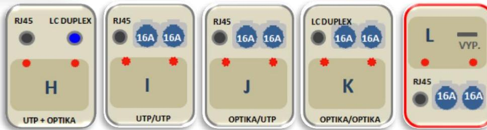
Als Kundenlösung kann auch LC DUPLEX Stecker eingesetzt werden und die Anschlussvariante für die Schalttafel realisieren wir als „K“ Typ
