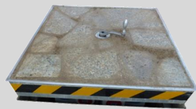
hotové dokončené víko s vlepěným kamenem. Výplň nesmí být výše, než je nerezový rámeček víka!!!
