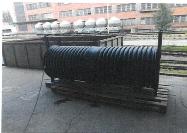
Obr. 3 : Sestava pro vnější přetlak ( multikanál vložen dovnitř sestavy )
